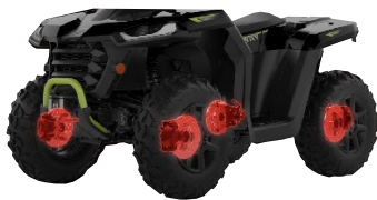
4 Freins à disques sur la version longue
