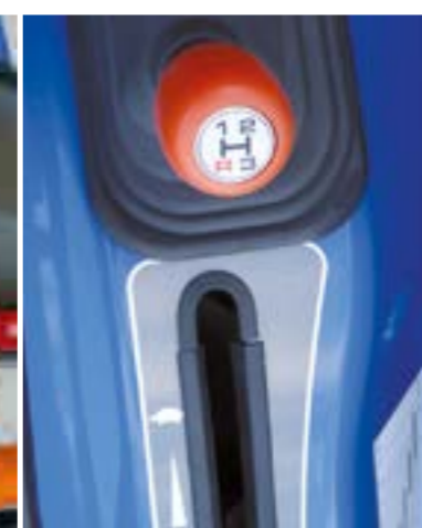
LEVIER DE VITESSE ERGONOMIQUE Ce levier est à portée de main afin de faciliter le changement de vitesse lors du travail.
