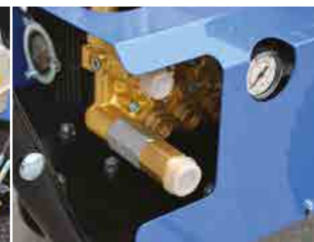
POMPE TRIPLEX Pistons céramique, culasse en laiton
