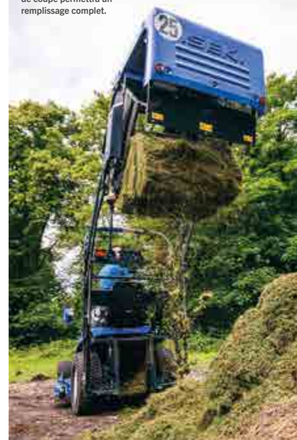
Le bac de ramassage SXG590S permet de vidanger le gazon uniquement au sol.
