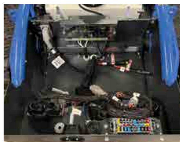
COMPARTIMENT ÉLECTRONIQUE câbles de communication pour pilotage des moteurs, déverrouillage du frein, point d'accès pour les lignes CAN bus etc...
