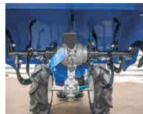
BINEUSE 55 CM Avec contre-rotation des fraises
