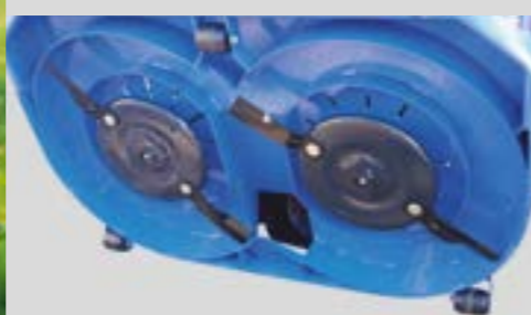
SF552 & SF583 : plateaux de coupe 152 ou 180 cm avec 2 x 2 lames escamotables montées sur portes lames
