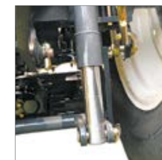
RELEVAGE PAR VÉRINS SURDIMENSIONNÉ
