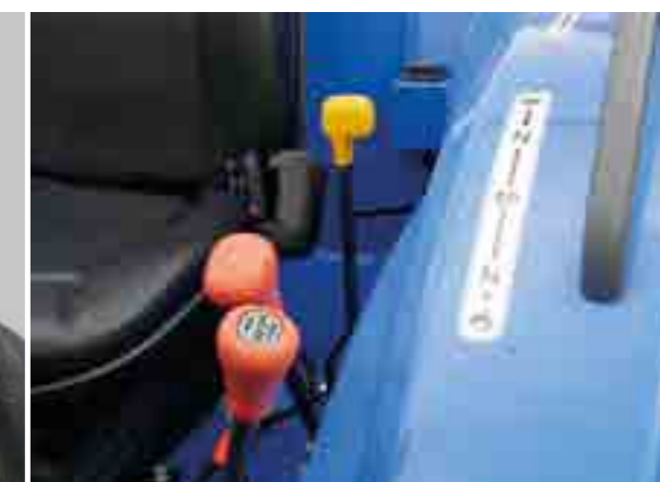
COMMANDES ERGONOMIQUES prise de force arrière, gamme de vitesses et frein à main
