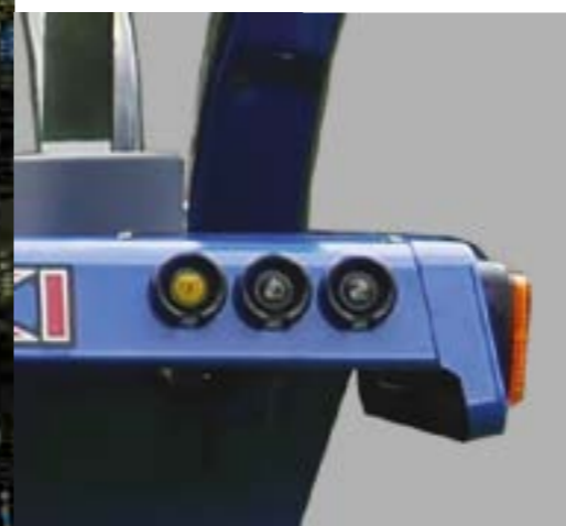
COMMANDE DE RELEVAGE et de la prise de force sur l'aile gauche
