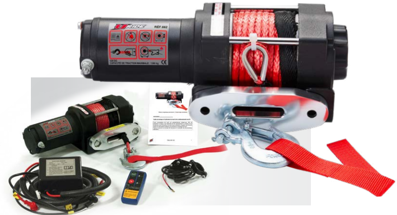
RÉF : 662 TREUIL QUAD NYLON > Commande au guidon ou télécommande sans fil > Traction : 1360 kg / Poids : 8 kg > Beaucoup plus léger qu'un treuil à câble acier , 2kg de moins > Grande longévité en utilisation difficile (eau, sable, boue, sel) > Boîtier de contrôle étanche en 12V > Câble nylon synthétique de diamètre 4,8mm et de 13m de long > Embrayage à glissement, verrouillable avec poignée latérale > Dimensions : 315 x 105 x 105 mm
