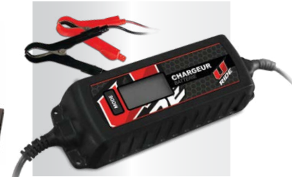
RÉF : 681 CHARGEUR BATTERIE > Tension d'entrée : 220-240V, 50Hz > Tension de sortie : 6V / 12V > Intensité de charge : 0.8A/3.8A > Capacité de la batterie : 1,2-120Ah > Dimensions du boîtier : 184 x 66 x 45 mm
