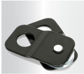
RÉF : 151 POULIE DE MOUFLAGE Permet de dévier la force et de la répartir afin de doubler la force de traction d'un treuil. > Capacité charge max : 4000 kg > Diamètre de la poulie : 64 mm
